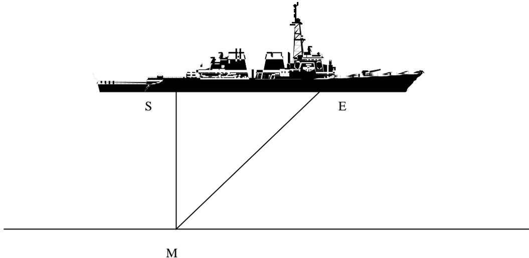
Ein Schiff bestimmt die Wassertiefe mittels Echolot. Dieses sendet senkrecht nach unten ein Schallsignal aus, dessen Echo im Empfänger nachgewiesen wird.
